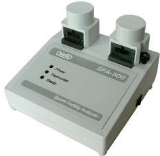
Sol bölme ölçüm bloğudur. Sağ bölme dijital mikroskop bloğudur.
